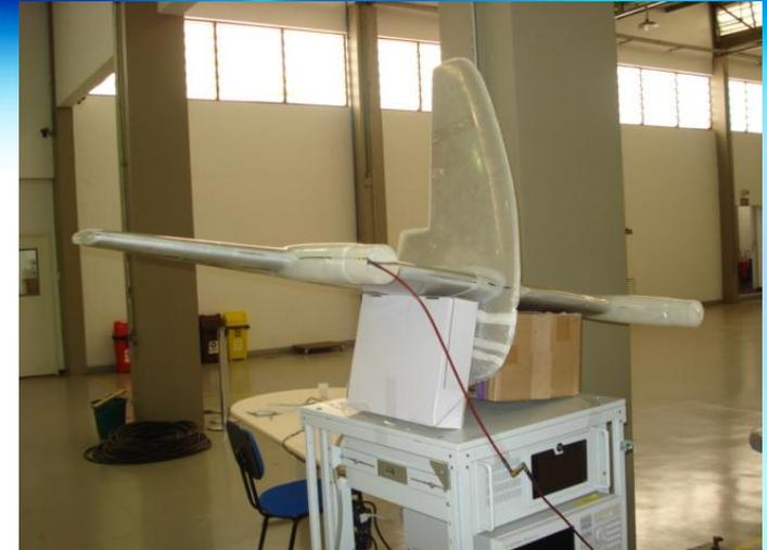
antena banda P integrada a Profundor
