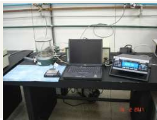
Padrão Nacional de Pressão (Lapre/Inmetro) e Sistema de calibração de pressão atmosférica do INPE/CPTEC/LIM
