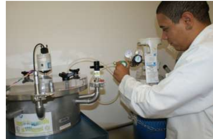
Sistema de calibração de pressão utilizando câmara barométrica e gás nitrogênio (99,999% de pureza).
