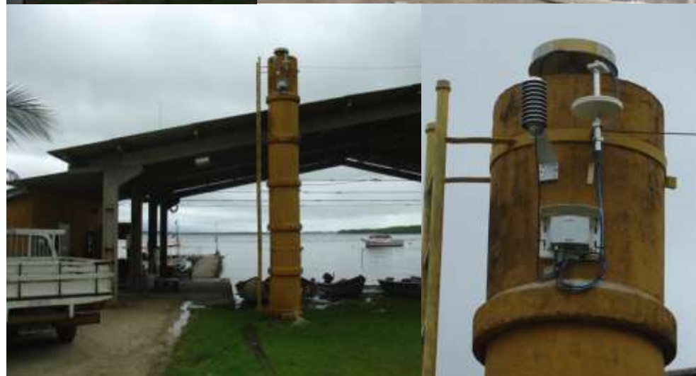
Estações de monitoramento (GNSS e PTU) de Araçatuba-SP e Cananéia-SP (PTU303 com "static pressure head")
