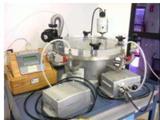
Padrão Nacional de Pressão (Lapre/Inmetro) e Sistema de calibração de pressão atmosférica do INPE/CPTEC/LIM
